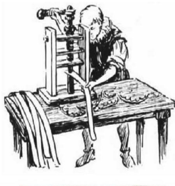
Обр. 7. Машина за изрязване на правилна кръгла форма на монетните заготовки Изображението е взето от < https://smolbattle.ru/threads/ >
