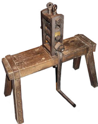
Обр. 6. Валцуваща машина, използвана за производство на лист с определена дебелина
